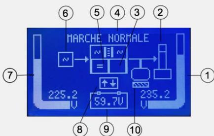
1. Barre graphe / multimètre tension de sortie
