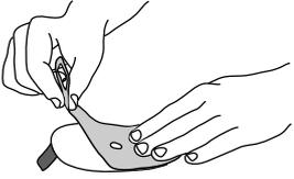
3. Appuyez fermement sur les électrodes afin qu'elles soient bien en contact avec le support jaune.
