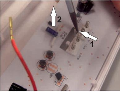
A l'aide d'un tournevis, déclipser la carte électronique des onglets de fixation, comme indiqué sur la photo
