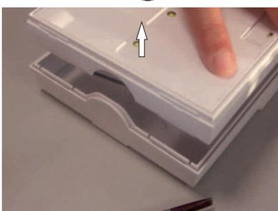
A l'aide d'un tournevis, retirer le réflecteur, en faisant levier, comme indiqué sur la photo.
