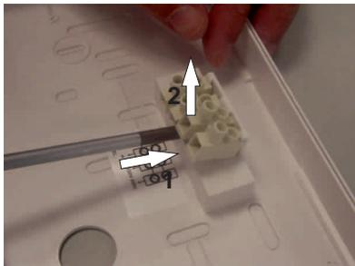
Retirer les bornes de connexion à l'aide d'un tournevis, comme indiqué sur les photos.
