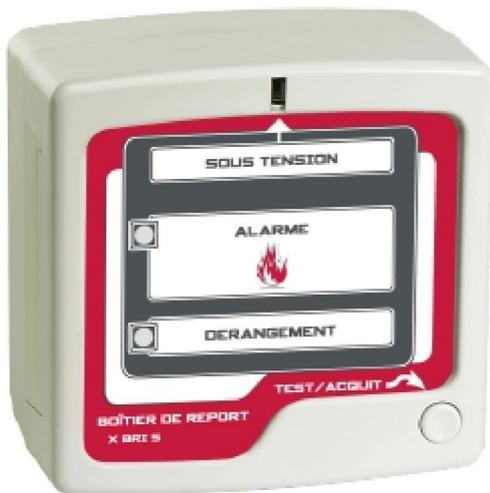
Ce boîtier de report permet de recevoir à distance, la signalisation visuelle et sonore des informations d'alarme et de dérangement en provenance d'un équipement de sécurité incendie. Le boîtier de report sera généralement placé dans un local décentralisé (par exemple : loge de gardien, accueil, poste de sécurité....)
