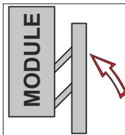
Réarmer le module en relevant la face avant du module jusqu'à l'accrochage de l'ensemble.
