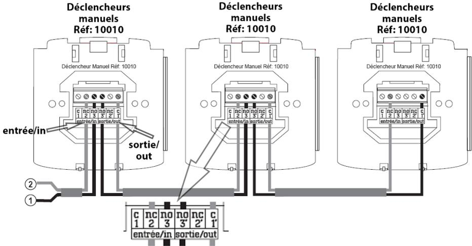
L'ouverture de la boucle de commande d'alarme générale déclenche le processus d'alarme pour une durée de 5 minutes. L'utilisation du boîtier de télécommande de mise à l'arrêt est impossible tant que l'alarme est activée !
