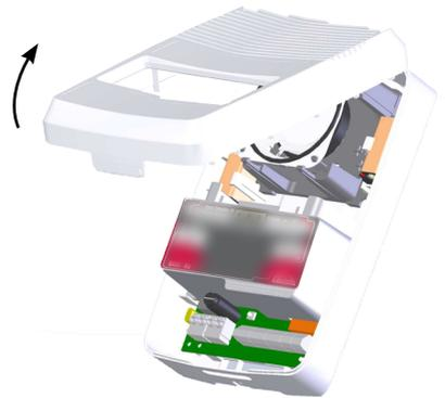
Lors de la fermeture du boîtier, ne pas oublier de remettre la vis.
