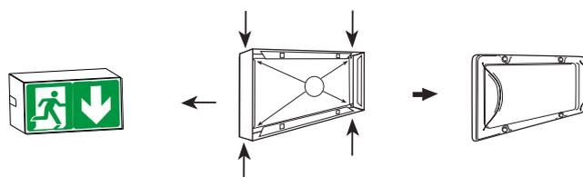
• Fixation du diffuseur sur le socle en acier.
