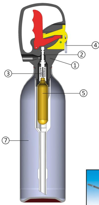
① La vanne est constituée de résine acétal assurant la protection contre la corrosion.
