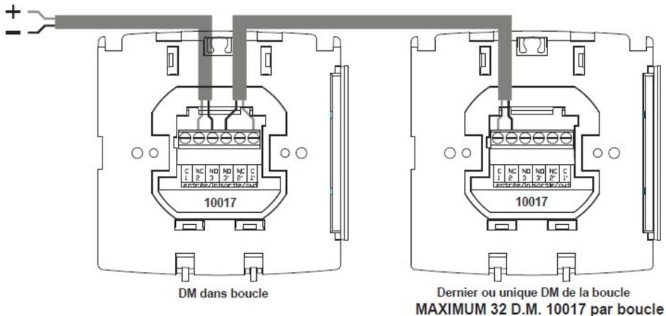
L'ouverture de la boucle de commande d'alarme générale déclenche le processus d'alarme pour une durée de 5 minutes. L'utilisation du boîtier de télécommande de mise à l'arrêt est impossible tant que l'alarme est activée !
