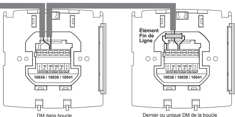
Câble à utiliser pour le raccordement :
